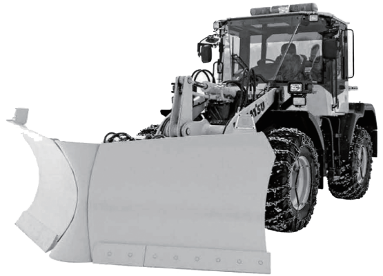
☒ 川内庁舎に配備予定の除雪ドーザ(11t級)
