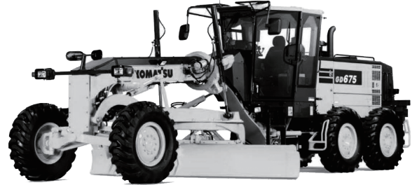
☒ 本庁舎に配備予定の除雪グレーダ(3.7 m級)
