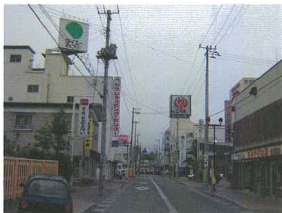
田名部駅前通り。歩道が狭く、電柱や路上駐車車両なども歩行の妨げとなっている。歩車道の段差をなくすべきとの指摘もある。
