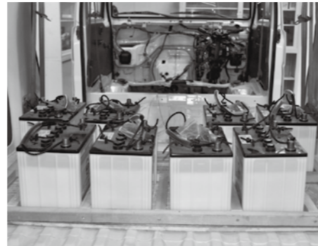
総重量184キログラムのバッテリー。木製のボックスに収まる。
