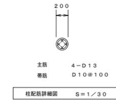
柱配筋詳細図 S=1/30
